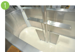
1 原料乳を低温条件で加熱殺菌し、チーズバットに入れる
