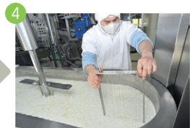
4 凝乳をピアノ線のカードナイフで切断する。小さく細断された固まりを「カード」という
