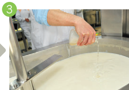
3 発酵した牛乳を固めるためのレンネット(凝乳酵素)を加える。この固まった牛乳全体を「凝乳」と呼ぶ
