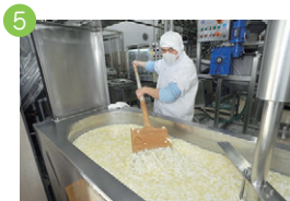
5 全体を静かに攪拌しながら徐々に温度を上げる。1時間ほど加熱すると、カードからホエイが出て組織がしまり、弾力のあるカード粒となる
