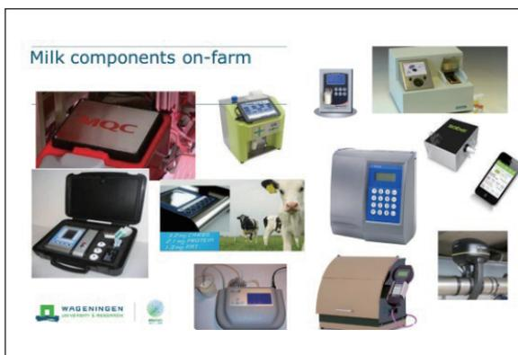
搾乳では、ロボットやミルクングパーラーに接続することによって、搾乳中にBHB ( $\beta$ -ヒドロキシ酪酸)などの、乳成分を調べることができます。
